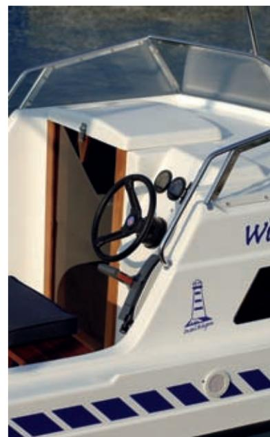
Der GFK-Rumpf ist im Handauflegeverfahren laminiert und durch seine spezielle Form bestens für die rauen Bedingungen der Küste geeignet. Die Wittow 520 K hat einen geschützten festen Führerstand mit Windschutzscheibe.
