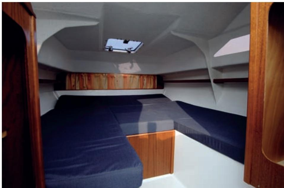
In der Kajüte befinden sich zwei feste Kojen, die durch ein optionales Einlegelegeteil zu einer Liegefläche von 2,10 m x 1,75 m erweitert werden können.
