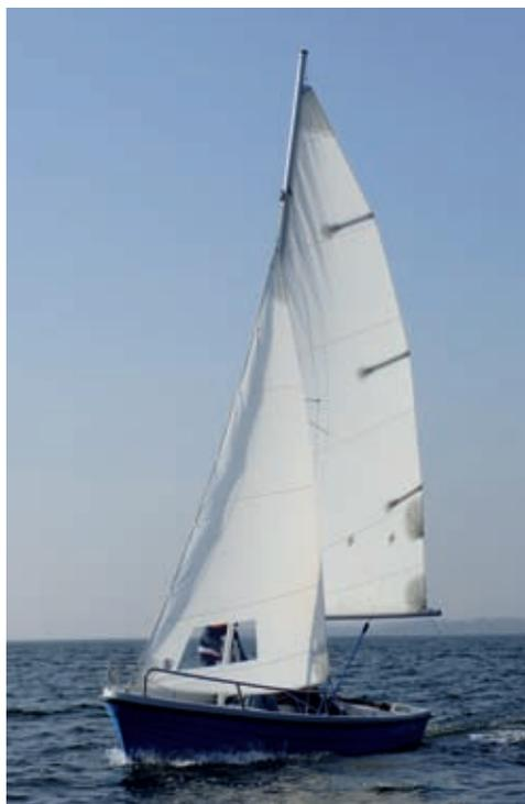
Die Takelage und die Beschläge sind zweckentsprechend einfach. Alle Beschläge sind korrosionsschutz oder aus rostfreiem Stahl. Als sichere Stoßkante ist eine Scheuerleiste aus PVC-Profil angebracht.
