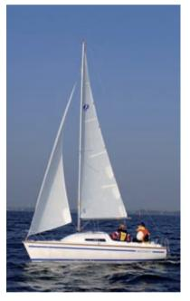
7/8 Alu-Rigg mit hochwertigen Beschlägen aus Alu, eloxiert oder Edelstahl. Vorstag und Wanten aus Edelstahl, Großbaumniederhalter, integrierte Schienen für verstellbare Fockschotführung, zwei Fockschotwinschen mit Curryklemme, eine Reffleine im Großbaum
